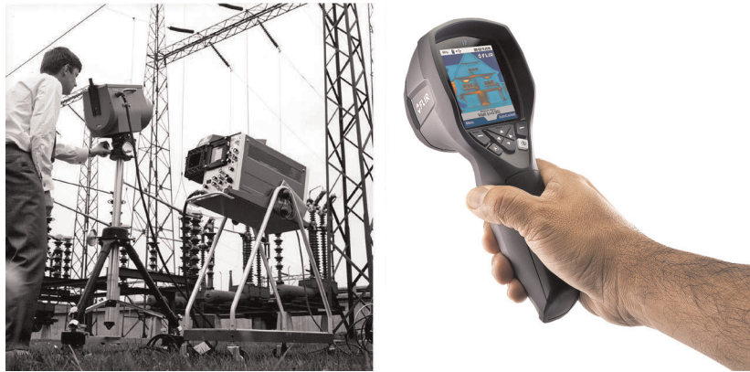
Abbildung 25.2 LINKS: Modell 661 der Thermovision aus dem Jahr 1969. Die Kamera wog ca. 25 kg, das Oszilloskop 20 kg und das Stativ 15 kg. Für den Betrieb wurden darüber hinaus ein 220-Volt-Generator und ein 10-Liter-Gefäß mit flüssigem Stickstoff benötigt. Links neben dem Oszilloskop ist der Polaroid-Aufsatz (6 kg) zu erkennen. RECHTS: Die FLIR i7 aus dem Jahr 2012. Gewicht: 0,34 kg einschließlich Akku.
