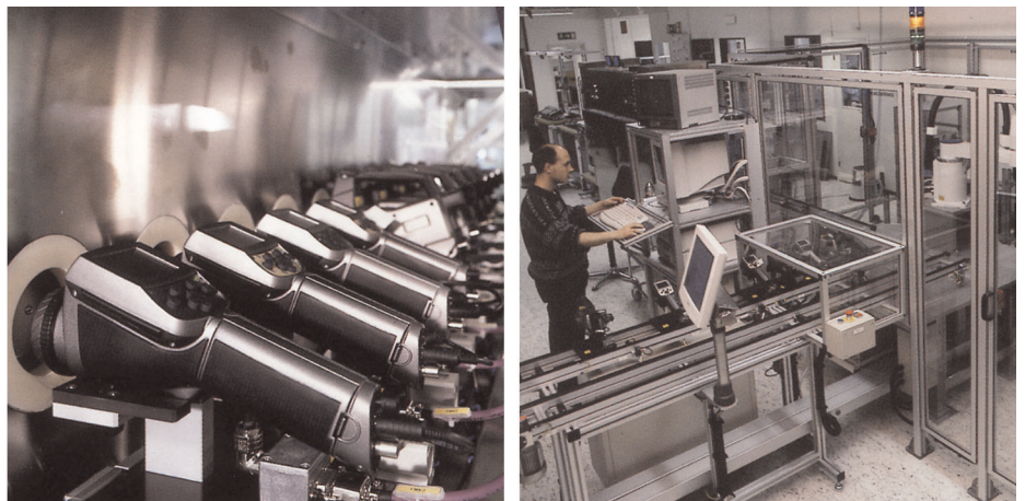
Abbildung 25.5 LINKS: Testen von Infrarotkameras in der Klimakammer; RECHTS: Roboter zum Testen und Kalibrieren von Kameras
