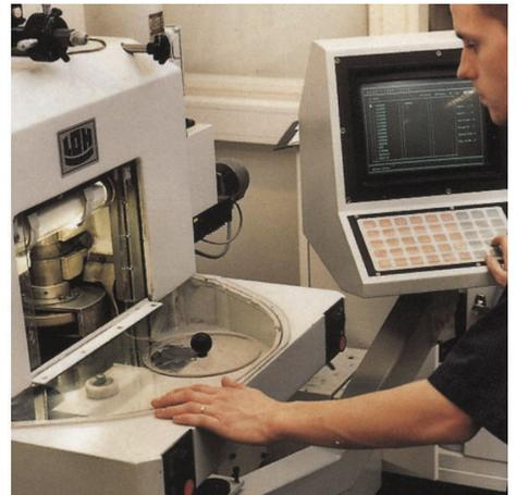
Abbildung 23.4 LINKS: Diamantdrehmaschine RECHTS: Schleifen eines Objektivs
