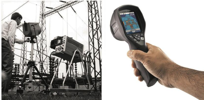
**Abbildung 23.2** LINKS: Modell 661 der Thermovision aus dem Jahr 1969. Die Kamera wog ca. 25 kg, das Oszilloskop 20 kg und das Stativ 15 kg. Für den Betrieb wurden darüber hinaus ein 220-Volt-Generator und ein 10-Liter-Gefäß mit flüssigem Stickstoff benötigt. Links neben dem Oszilloskop ist der Polaroid-Aufsatz (6 kg) zu erkennen. RECHTS: Die Flir i7 aus dem Jahr 2012. Gewicht: 0,34 kg einschließlich Akku.
