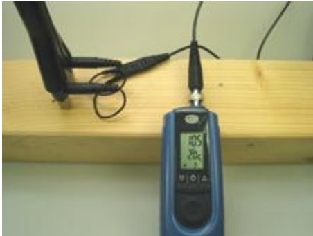
Abbildung 4-1 Messung quer zur Faserrichtung mit M 20
