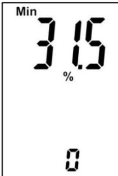
Soll ein Minimalwert gelöscht werden, muss der angezeigte Wert durch einen *kurzen* Druck auf die „M“-Taste angewählt werden.
