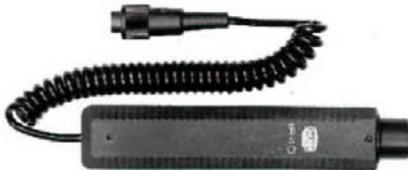
zur berührungslosen Oberflächen-Temperaturmessung im Bereich von - **20,0 bis +199,9 °C**. Auflösung 0,1 °C. Ein idealer Fühler zur Taupunkt-Messung und Aufspürung von Wärmebrücken.
