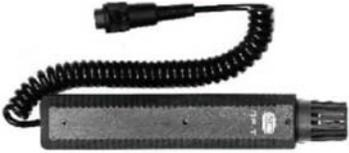
Aktive Sonde mit integrierter Elektronik zum zerstörungsfreien Aufspüren von Feuchtigkeit in Bauteilen aller Art sowie zur Erkennung der Feuchtigkeitsverteilung in Wänden, Decken und Fußböden. Die nach einem patentierten Messverfahren arbeitende Elektrode erzeugt ein konzentriertes Hochfrequenzfeld mit einer Tiefenwirkung bis zu 120 mm.
